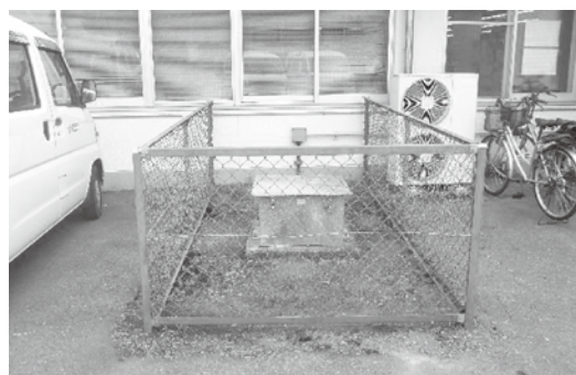
市役所敷地内の震度計
