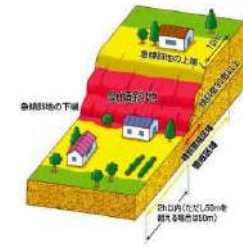
急傾斜地の崩壊
